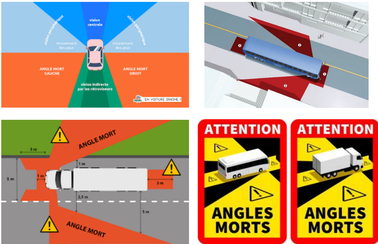
Figure 15: Angles morts des véhicules motorisés
