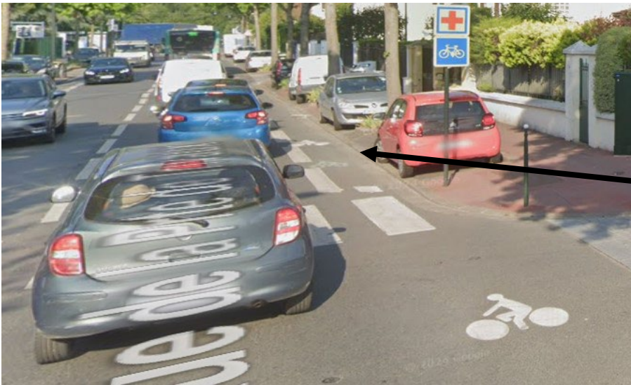
Figure 5: exemple d'une bande cyclable, aménagement peu adapté à une route large et fortement circulée
